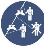
Das Absturzschutzsystem kann gleichzeitig von mehreren Benutzern so gebraucht werden, dass in jedem dritten Feld maximal 1+1 Benutzer angeschlossen ist.
